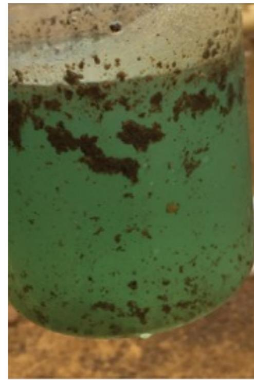
Brand X química produjo mínima extracción de parafina en el extremo de la tubería
