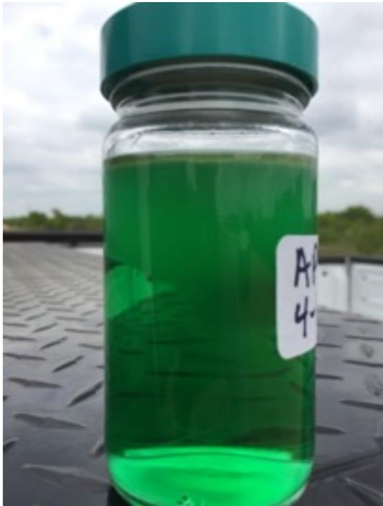
APS; químico inyectado en la tubería para eliminar la parafina
